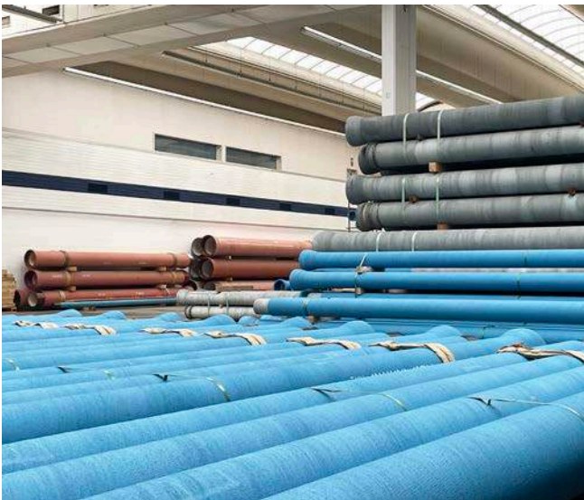
Les tuyaux FZM sont en service pour l'eau potable (bleu) ainsi que pour les eaux usées (brun rouge).
